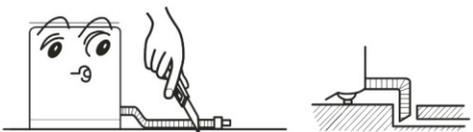
4. 需加长排水管时，请另购排水管，加长排水管的内径应不小于30mm，长度应不大于1.5m。
