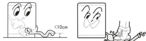
3. 排水管不需要太长时，可从中间部位切除，为了排水流畅，可将排水管前端斜切。
