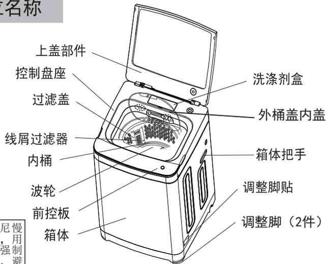
注意：采用阻尼慢落上盖的机器，用户合盖时不要用力按压上盖，避免损伤阻尼系统，降低阻尼系统的寿命。
