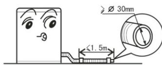
5. 加长排水管过长时，可从A或B两处切除排水管。
