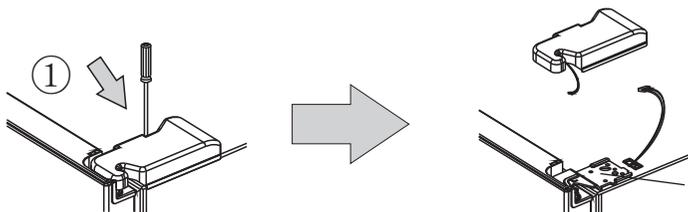
2. 逆时针旋转铰链螺钉③和螺钉②，将其拆除并卸下上部的铰链④，小心冷藏室门在拆除过程中不要滑落。
